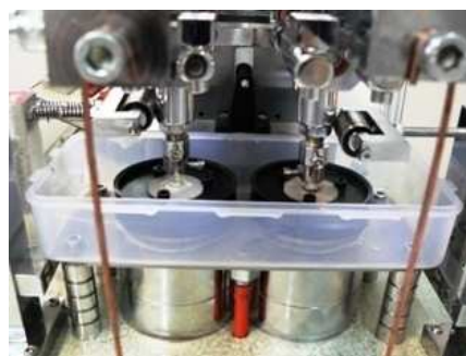
شکل ۴. قرارگیری هم‌زمان ۲ نمونه در دستگاه سایش
