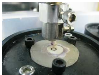
شکل ۵. عمود قرار گرفتن نوک کاسپ بر سطح سرامیک
