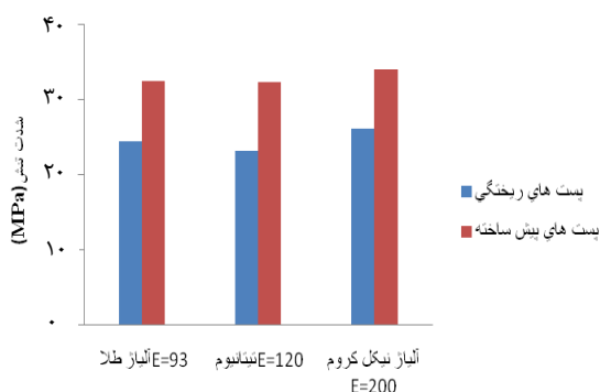
نمودار ۳. حداکثر تنش‌های کششی در دندان‌های بازسازی شده با پست‌های پیش‌ساخته و ریختگی
