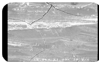
شکل ۲. نمای سطح زیرکونیا پس از تابش با لیزر CO 2 با بزرگ‌نمایی ۱۰۰۰x (سطحی خشن با ظاهری فلس مانند به همراه میکروترک)
