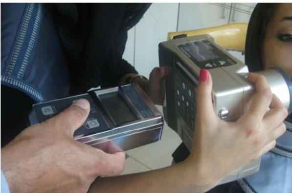
شکل ۳. اندازه‌گیری دوز اشعه توسط دستگاه دوزیمتر گایگرمولر در پشت دستگاه PORT-XII
